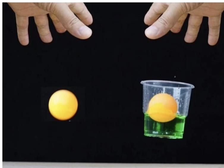
浅析：一个经典的能量转换实验。在受到撞击后，液体会像中间聚集，中部液体向上快速弹起将动能传递给乒乓球，乒乓球质量小从而获得较大动能后以较大初速度弹起，进而弹起较高高度。本问题中给定的参数是水的体积，简单来想优化的目标就是容器形状。最简单的考虑，容器都是圆柱体，则可以自然地问：圆柱内液体体积固定，是半径大的圆柱好还是瘦长的圆柱好(让乒乓球弹起更高)？这部分研究需要建立液体动能向乒乓球传递的定量关系式，然后分析乒乓球获得动能大小对液体初始半径、高度的依赖关系后，确定具体优化方式。
