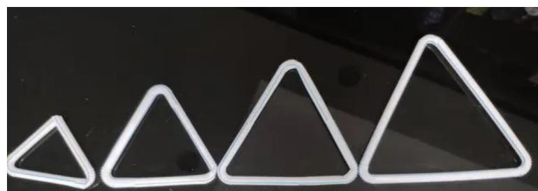
浅析：本问题的关键是所设计的简单水泵将水泵至高处的压力来源。题目所描述过程已经提示我们，这一压力来源是旋转。简单思考便知，是因为旋转导致习惯中水受到的离心力通过管子的特殊弯折（三角形）将水压至上方。本问题中，转速和几何形状（三角形的特征）如何影响泵水速度是需要讨论的核心。
