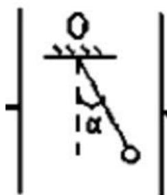
浅析：本文的力学基础很简单，点电荷在匀强电场（近似）中的平衡。显然不同电荷量的小球会偏转的角度不同（角度由小球受到的电场力和重力的比例确定），若需要对电荷测量尽可能灵敏，则需要电荷变化后角度的响应足够灵敏。理论上用偏导关系得到电荷关于角度的误差传递公式来分析这一灵敏度是非常直接的。实验上，本题目的量化和测量都比较简单。
